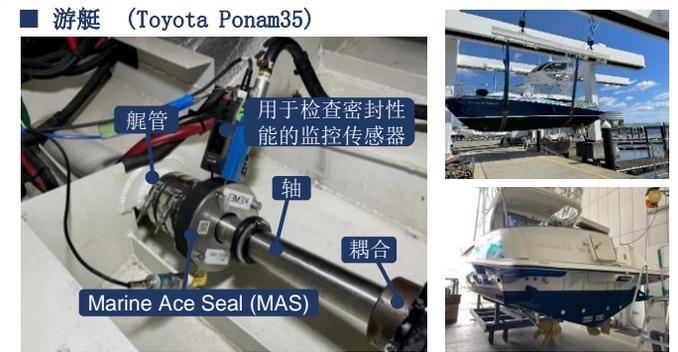
Marine Ace Seal 密封件上安装了多个传感器，以获取检查多种驾驶模式下密封件性能。
